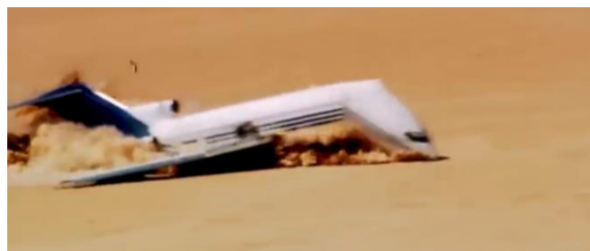
Rys. 10. Doświadczenie z samolotem Boeing 727-200 na pustyni w Meksyku w dniu 27.04.2012. Film pokazuje sposób niszczenia konstrukcji podczas uderzenia w ziemię [7].
