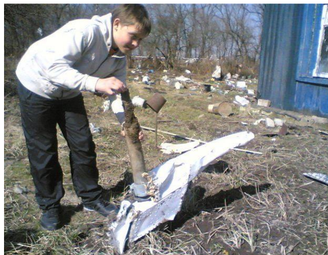
Rys. 13. Napęd zewnętrznej kłapy lewego skrzydła wraz z fragmentem kłapy znalezionej u podnóża brzozy Bodina [11].
