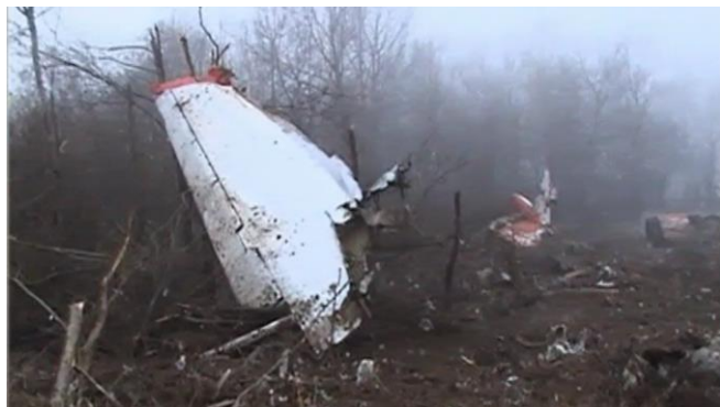
Rys. 22. Końcowa część prawego statecznika ze sterem wysokości. Widok dolnej powierzchni. Krawędź natarcia jest po prawej stronie. Dolna część statecznika ma fragment oderwany w kierunku lotu [18].
