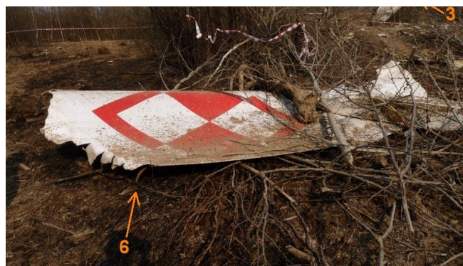
Rys. 25. Fragment pokrycia dolnej powierzchni końcówki lewego skrzydła z fragmentem owiewki prowadnicy klap (6), w tle prawy statecznik poziomy (3) [17]. Górna poszycie zostało rozdrobione i jego kawałki leżą w odległych miejscach.
