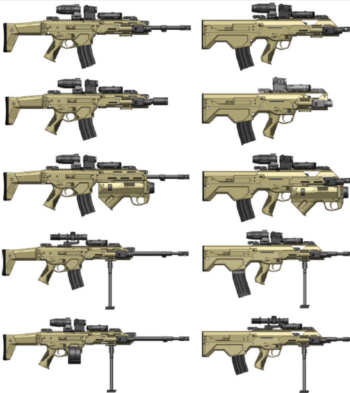
Rys. 1. Docelowa struktura MSBS-5,56: A – MSBS-5,56K (od góry): karabinek podstawowy (standardowy), subkarabinek, karabinek-granatnik, karabinek wyborowy, karabinek maszynowy, B – MSBS-5,56B (od góry): karabinek podstawowy (standardowy), subkarabinek, karabinek-granatnik, karabinek wyborowy, karabinek maszynowy
